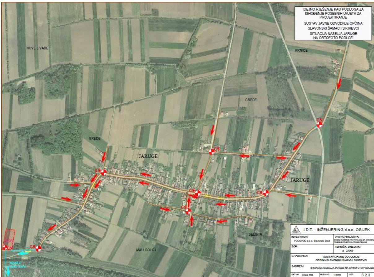
Fotografija 6: Idejno rješenje sustava javne odvodnje naselja Jaruge
